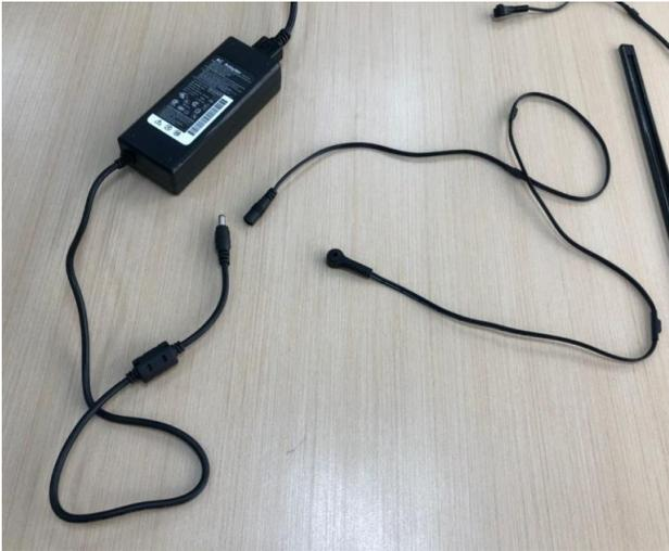
1. 將②旋卡連接線母頭端與變壓器連接
